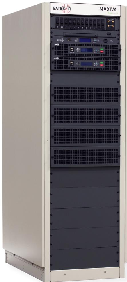
Amplificateurs de puissance haute efficacité optimisés pour des niveaux de puissance égaux avec une modulation ATSC 1,0 ou ATSC 3,0
