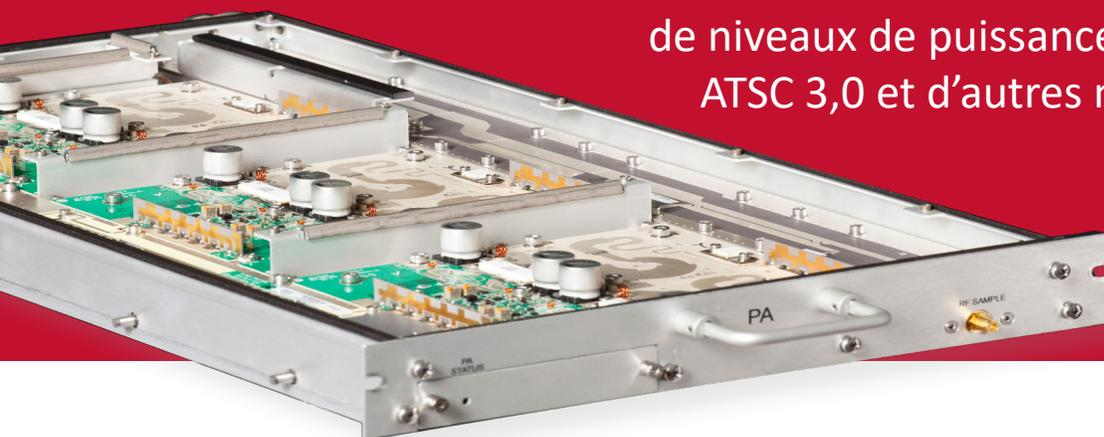
Conçu pour les besoins futurs en matière de radiodiffusion, l'émetteur ULXTE est capable de niveaux de puissance égaux pour ATSC 1,0, ATSC 3,0 et d'autres modulations OFDM.
